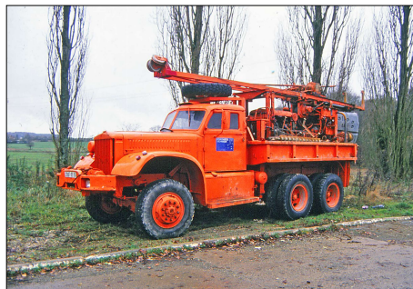
47 UT-LE MANS (72) Diamond T 969 A. Foreuse d'une entreprise de TP. © A. LESAUX-1992 .
