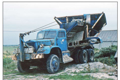
48 UT-CAYEUX-SUR-MER (80) Diamond T 969 A. Equipé d'une concasseuse à galets. © A. HORB-1978 .
